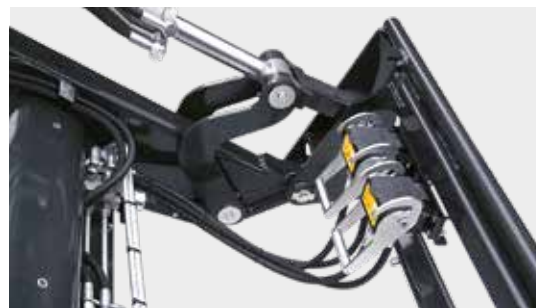
Para una conexión rápida y cómoda de los latiguillos, utilice el Tool-Fix.
