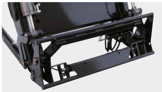
Bloqueo y desbloqueo de implementos desde la cabina, sin tener que bajar del tractor. Solo con el Hydro-Lock.
