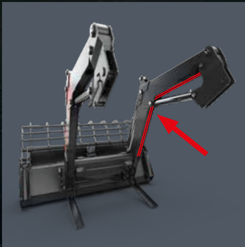
Colocación de tuberías para el REAL3 rd
