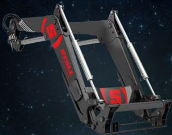
Palas FZ con paralelogramo mecánico: Solución robusta para profesionales.
