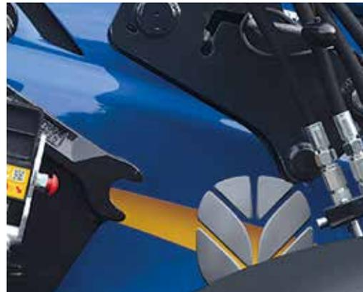
**1** Aproxime el tractor y deje que el pilar deslice por el anclaje hasta que el bulón superior llegue al final de la rampa.
