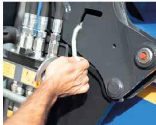
**3** Baje la palanca de cierre para que el montaje quede seguro. Levante más la pala.
