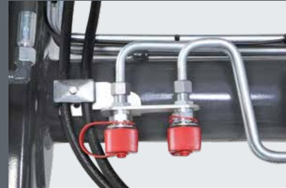
Para cualquier implemento que necesita una función hidráulica adicional (pinzas para pacas, cazos desensiladores, etc.).
