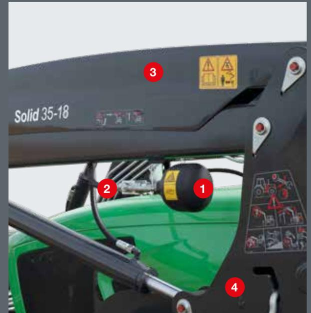
El Comfort-Drive queda protegido entre el pilar izquierdo y el brazo. Mediante la llave de paso puede conectarlo y desconectarlo cuando lo necesite.
