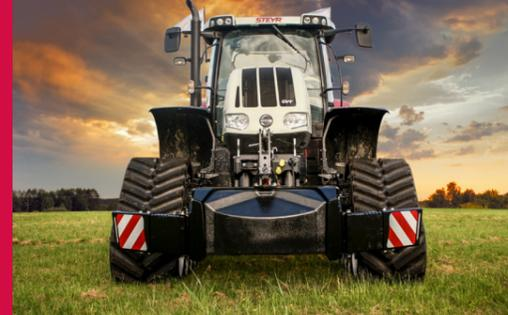
El Protector Frontal Zuidberg se instala fácil y rápidamente en el tractor, bien con un tripuntal o utilizando un marco A. El ancho del protector puede regularse entre 220 cm. y 295 cm. Selecciona el modelo que mejor se adapte a tu tractor para asegurar el complemento perfecto.
